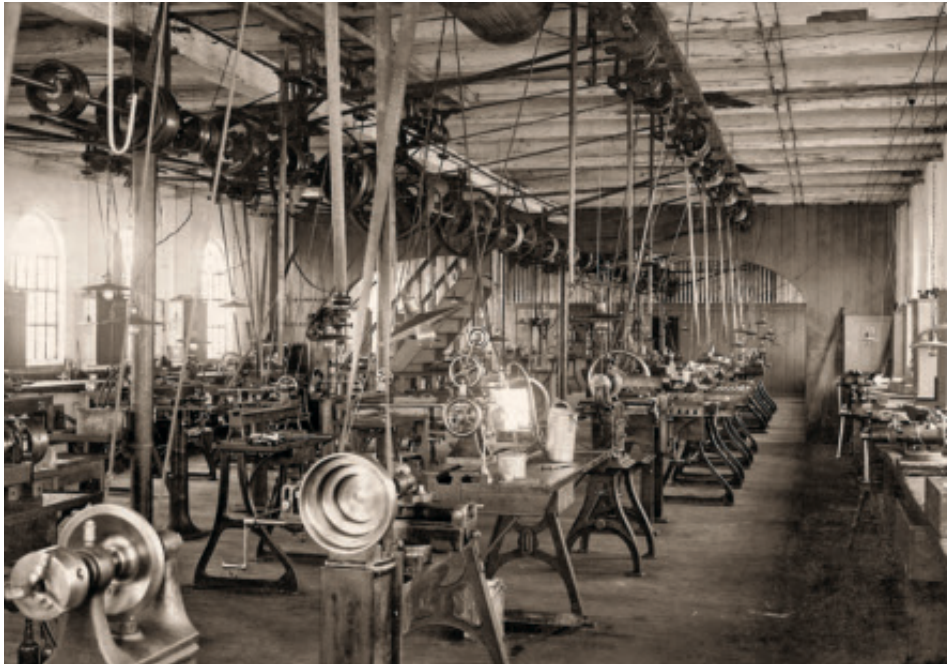
Maskinværkstedet på Bastian, indrettet i 1897 og nærmest uforandret frem til fabriksudvidelsen i 1937. Bemærk under loftet forlagsakslerne og remtræk ned til maskinerne.
